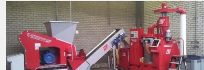
Kabelschredder: 1) Vorschredder 2) Granulierer 3) Vibrationstrenner
