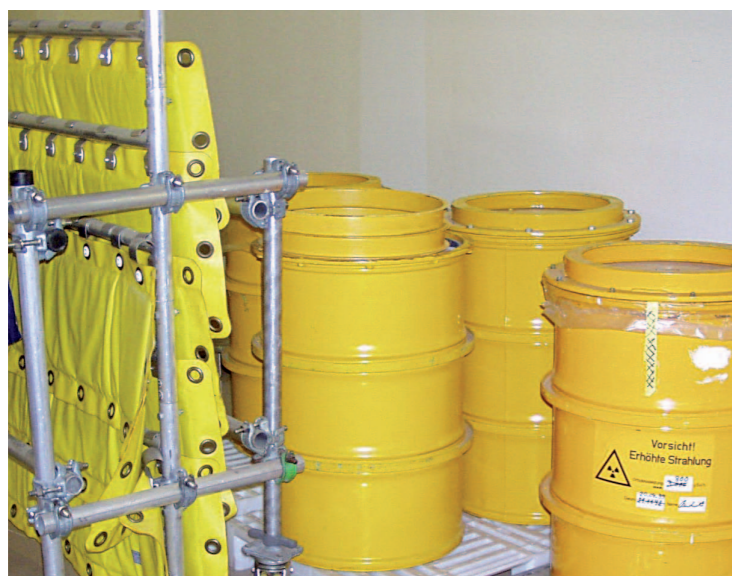
Radioaktive Abfallgebinde hinter Abschirmmaßnahmen.
