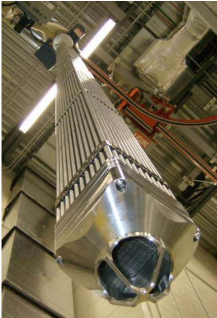
Ein Atrium 11-Brennelement enthält 11 x 11 Brennstäbe. Foto: Framatome GmbH
