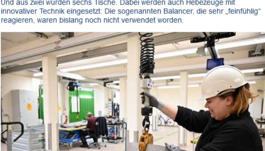
Messtechnikerin Jennifer Eberhard hebt gerade mit einem Balancer ein Teil der Turbinenschaukel aus Block B aus einem Transportbehälter.
