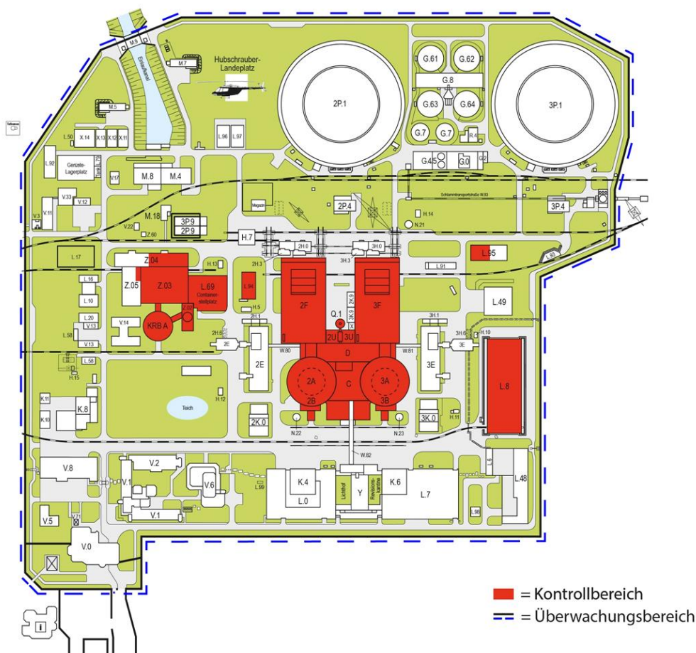
Abbildung 11: Überwachungsbereich und Kontrollbereiche am Standort
