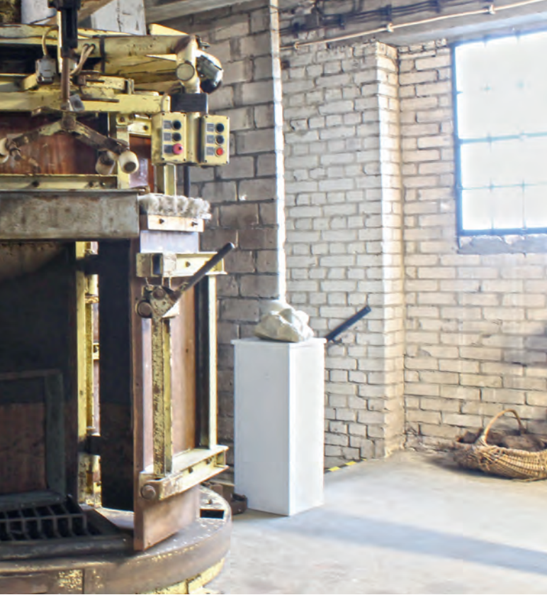
← TORFWERK: Die Karussellmaschine wurde seit den 1960er-Jahren zur Torfabfüllung im Hahnenmoor verwendet.
