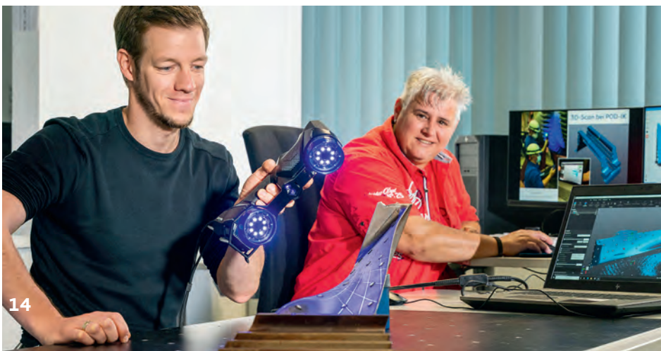
Sebastian Ortman und seine Kollegin Michaela Bäumler vermessen Teile mithilfe eines Handscanners bis auf Zehntelmillimeter genau.
