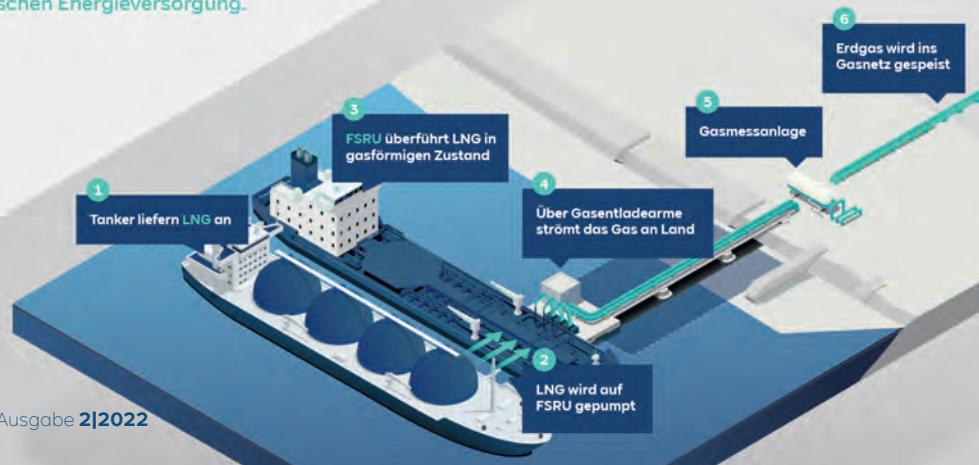
Jedes der Schiffe ist in der Lage, in einem Entladevorgang bis zu 170.000 Kubikmeter LNG von Tankern aufzunehmen, an Bord in Gas zu überführen und anschließend ins Gasnetz einzuspeisen. Mit den beiden 300 Meter langen FSRU können jährlich zwischen 10 und 14 Milliarden Kubikmeter Erdgas für den deutschen Gasmarkt verfügbar gemacht werden.
