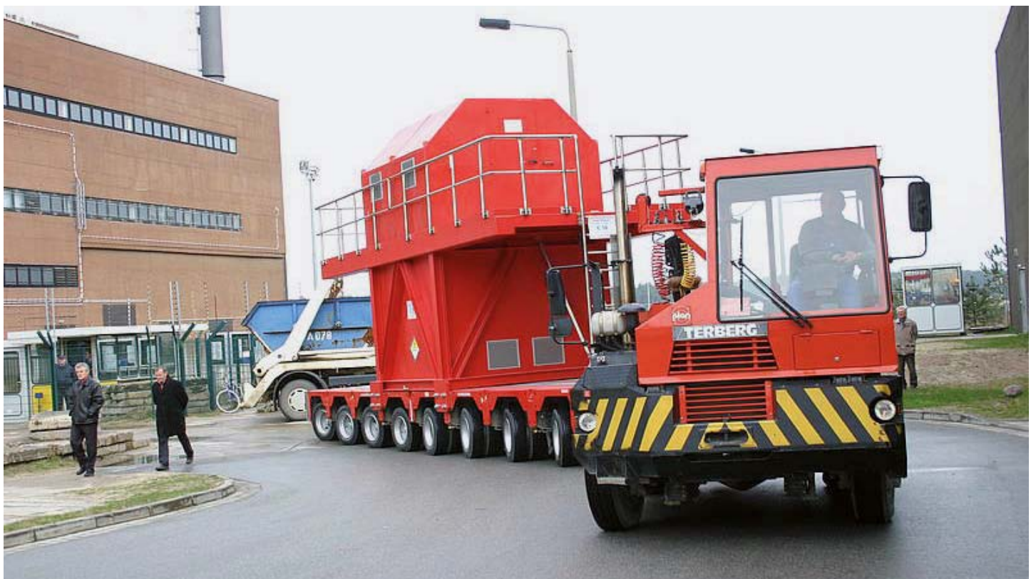
Abb. 21: Innerbetrieblicher Transport bestrahlter Brennelemente
