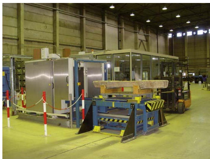
Abb. 33: Messung zur Freigabe von Abfall
